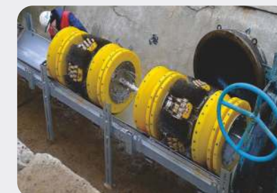
3차 PIGGING (BRUSH PIG) 잔류가능성 미세 이물질 제거
